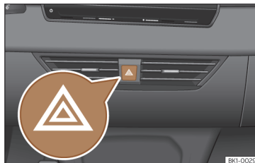
40. att. Instrumentu panelis: avārijas gaismu signalizācijas slēdzis.
