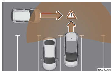
115. att. Izbaukšanas palīg-sistēmas darbības shēma: kontrolētā zona aiz automašīnas, kas izbrauc no stāvvietas.
