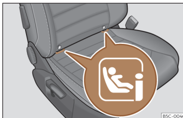
36. att. Priekšējā pasažiera sēdeklis: i-Size stiprinājuma cilpas.
