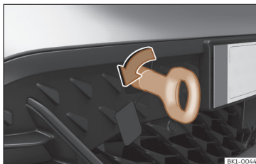
150. att. Priekšējā bufera labajā pusē: ieskrūvēta vilkšanas cilpa.
