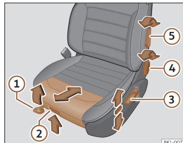
73. att. Priekšējie sēdekļi: sēdekļa manuāla regulēšana.
