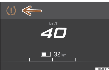
164. att. Mērinstrumentu bloks: brīdinājums par riepu spiediena zudumu.
