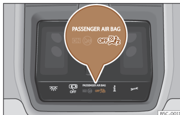
26. att. Griestu konsolē: kontrollampina, kas norāda, ka priekšējā pasažiera drošības spilvens ir atslēgts.
