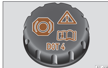
159. att. Priekšējais nodalījums: bremžu šķidruma tvertnes vāciņš.
