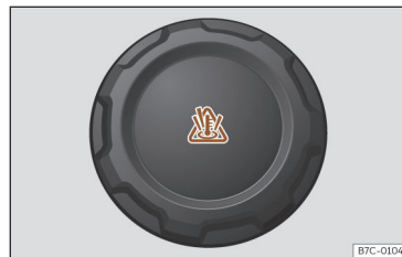
158. att. Priekšējais nodalījums: dzinēja dzesēšanas šķidruma izplešanās tvertnes vāciņš.
