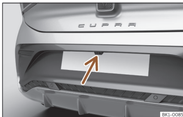
100. att. Aizmugurējā buferi: atpakaļgaitas palīgsistēmas kameras atrašanās vieta.
