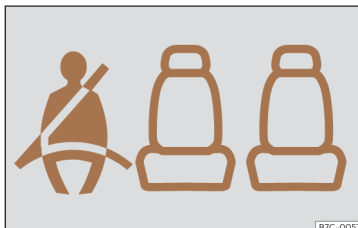
15. att. Mērinstrumentu bloks: drošības jostu statusa rādījums aizmugurējām sēdvietām.
