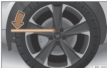
167. att. Riteņa nomaīņa: riteņa skrūvju palaišana vaļīgāk.
