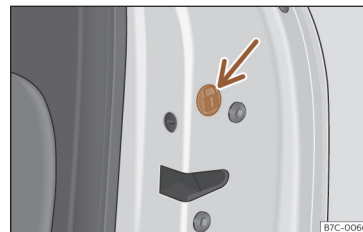
65. att. Durvju ārkārtas aizslēgs.
