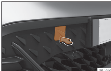
149. att. Priekšējā bufera labajā pusē: nosegvāciņa noņemšana.
