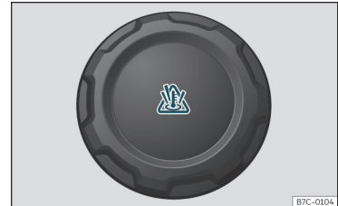
218. att. Motora nodalījums: dzinēja dzseses šķidruma izplešanās tvertnes vāciņš.
