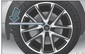
41. att. Riteņa nomaīņa: riteņa skrūvju palaišana vaļīgāk.
